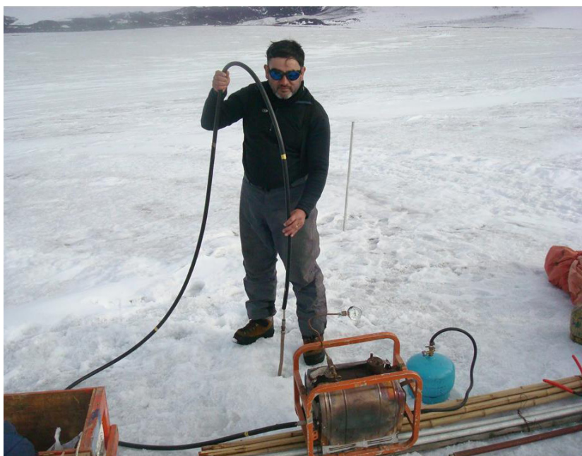
Figura 2.5: Perforaciones con perforadora de vapor.
