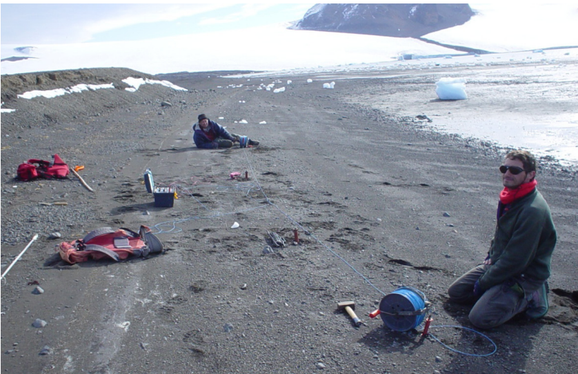
Figura 2.6: Tendido Geoelectrico 1D típico. Isla Vega, Antártida
